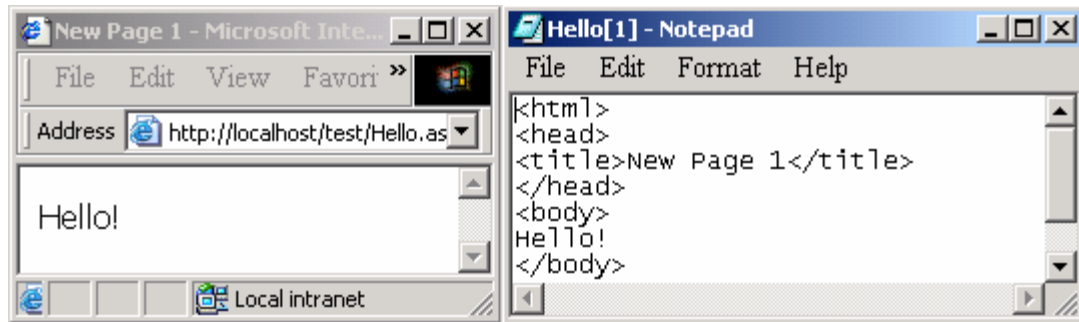
Hình 1.6 Trang ASP sau khi thực thi trả về cho client dưới dạng 1 trang web tĩnh. Browser không xem được mã nguồn của trang ASP
